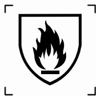
**Figura 1 – Exemplo para vestimenta de proteção contra calor e chama (ISO 7000 2417)**
